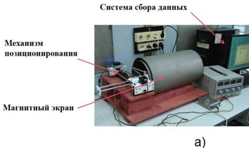
Рисунок 6.13 Сканирующий ГМИ-магнитометр: а) фотография общего вида ГМИ-магнитометра; б) фотография ГМИ-датчика с подводящими контактными .
